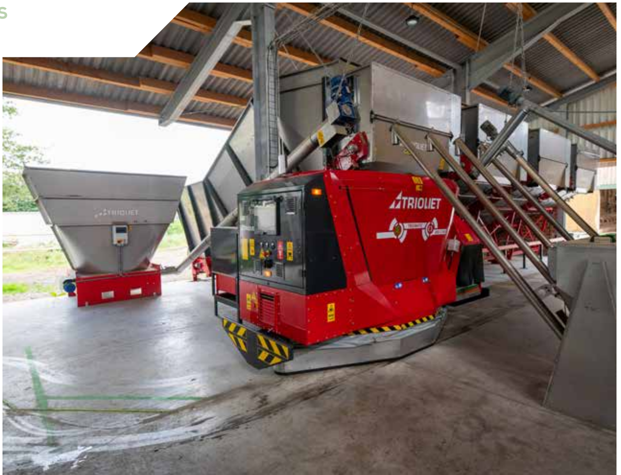
Búnker dosificador con sinfín de acero inoxidable, agitador, sinfín transversal y sinfín elevador
