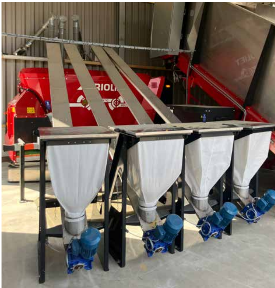
Dosificador de minerales con bolsa de almacenamiento de 120 l y sinfín de artesa de acero inoxidable
